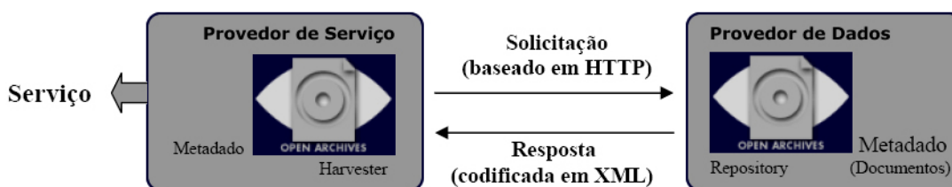
Figura 3: Esquema básico de funcionamento do protocolo OAI-PMH
